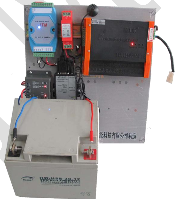
图 2：MV20A 系列采集箱内部配置
